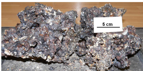
Obr. 1. Inkrustr ze spoluspalování hnědého uhlí a dřevní štěpky
