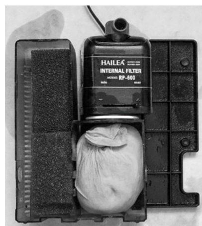
Obr. 2. Dvoukomorový filtr RP-600 s molitanovým filtrem (nacházející se v levé části obrázku) s konkrétním zeolitem umístěným v silonovém obalu
