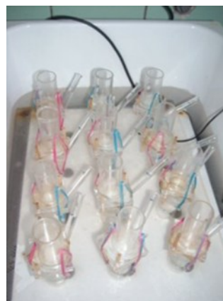
Obr. 2. Schéma Franzovy difuzní cely a sestava Franzových permeačních cel ve vodní lázni
