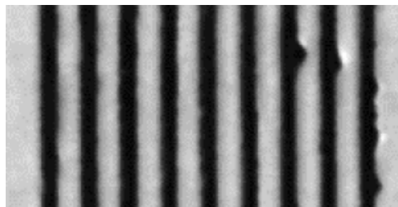
Obr. 4. Detail mřížky exponované AFM hrotem v rezistu PMMA; skenovací pole 1,7 \mu\text{m} \times 1 \mu\text{m} , tloušťka rezistu 25 nm, cit. 13
