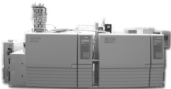
Obr. 3. Laboratorní pyrolýzní aparatura
